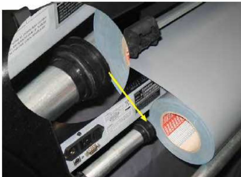
Rys. Założenie mediów bez użycia kołnierzy prowadzących.
